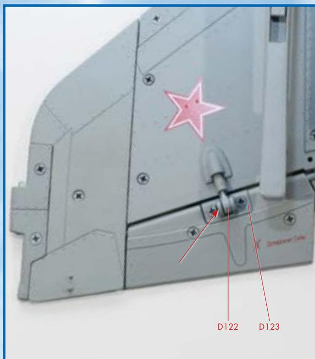
**6** Затем установите шток привода элерона (D122), как показано на снимке, и зафиксируйте его винтом QM.
