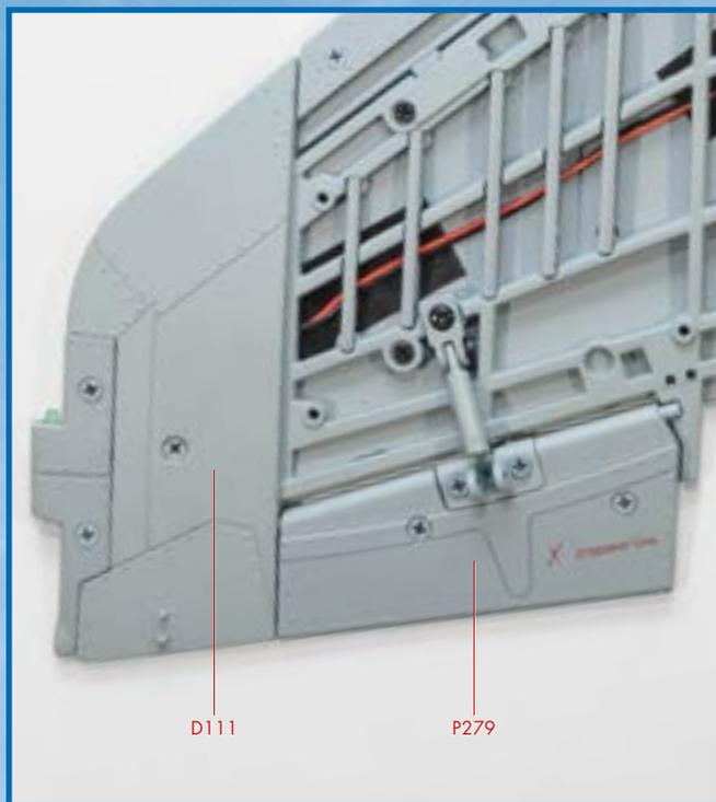
**3** Затем установите собранный элерон на каркас правой консоли крыла, как показано на снимке.
