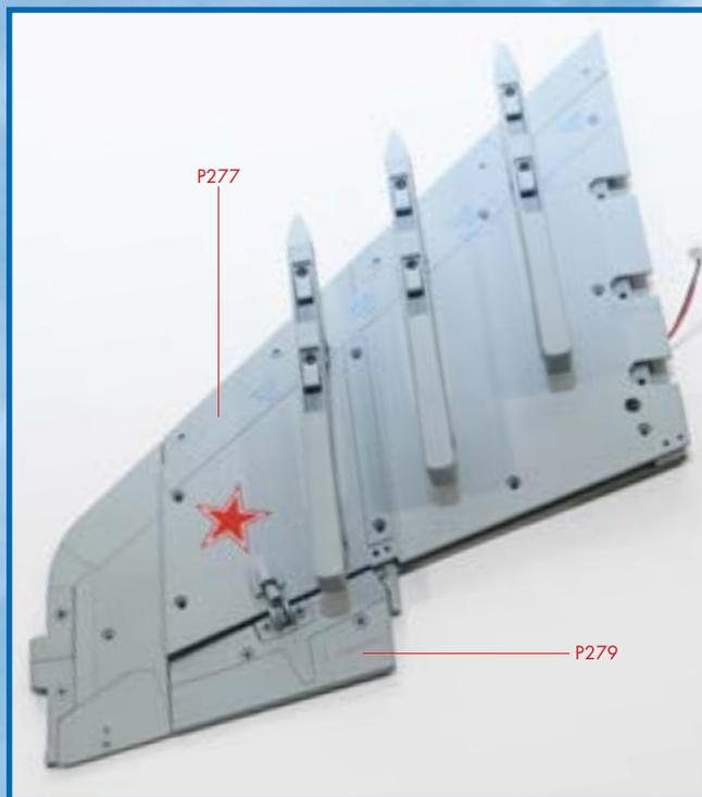
**4** Установите на каркас правой консоли крыла нижнюю поверхность крыла с пилонами, как показано на снимке. Для удобства монтажа рекомендуем предварительно снять обтекатель привода элерона, а затем установить его на место.
