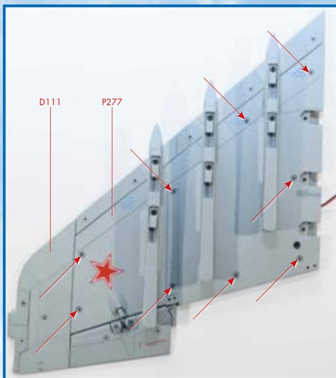
**5** Закрепите нижнюю поверхность консоли крыла винтами NM в местах, указанных на снимке.
